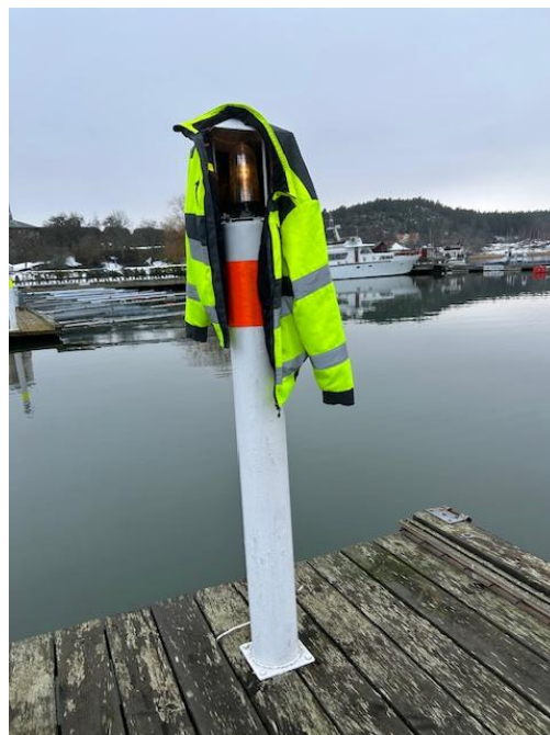
Här kontrolleras att skymningsrelät fungerar.
